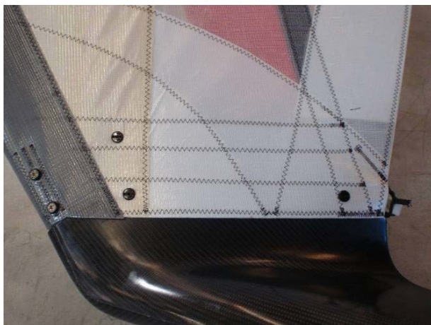
Рисунок 5-3: Фиксаторы законцовок крыльев
