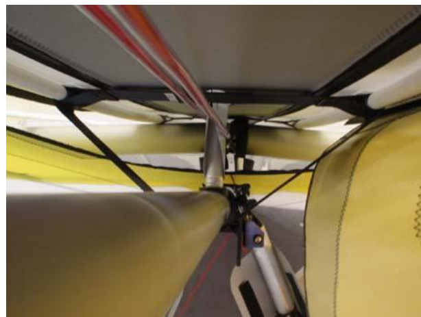
Рисунок 5-2: Путь тросов натяжения
