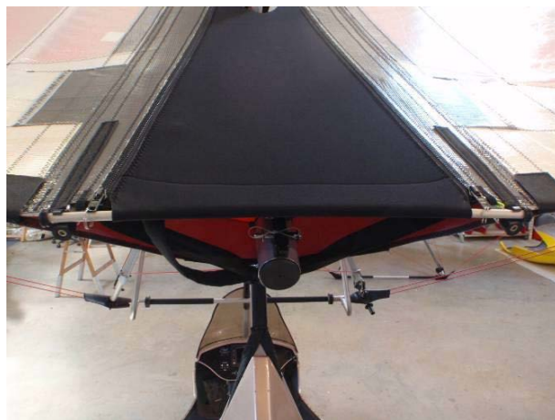
Рисунок 5-4: Поперечная лата задней кромки
