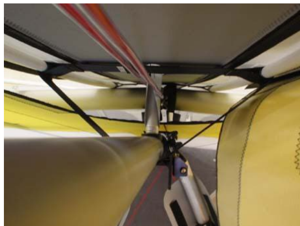
Рисунок 5-2: Путь тросов натяжения
